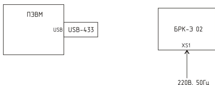
Рисунок 7 - Подключение оборудования для настройки
