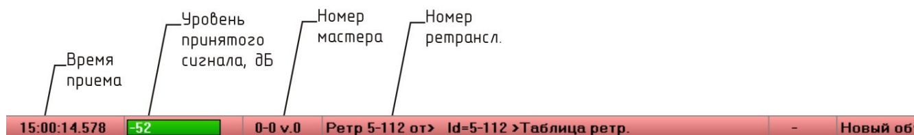
Рисунок 24 - Пример пакета «Таблица ретрансляторов»
